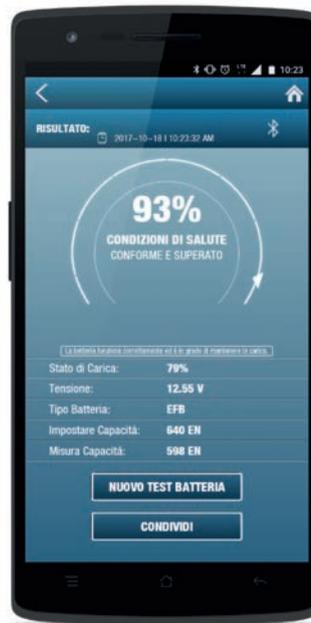
▲ Test de estado de la batería: eficiencia, estado de carga, voltaje y medición de corriente de entrada.
