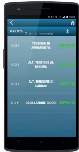
▲ Prueba de carga y circuito de arranque: tensión de arranque, tensión de ralentí, tensión de carga y oscilación residual.
